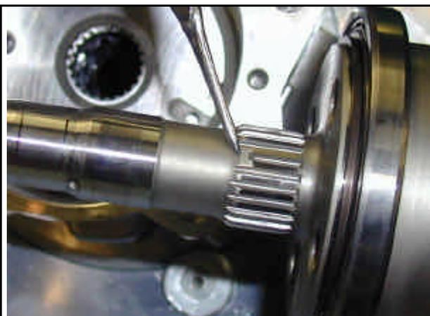
Controllare lo stato del millerighe di trascinamento pompa alimentazione, se presenta delle screpolature sulla cementazione.
