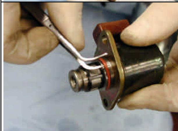
Levare la guarnizione inferiore del regolatore
