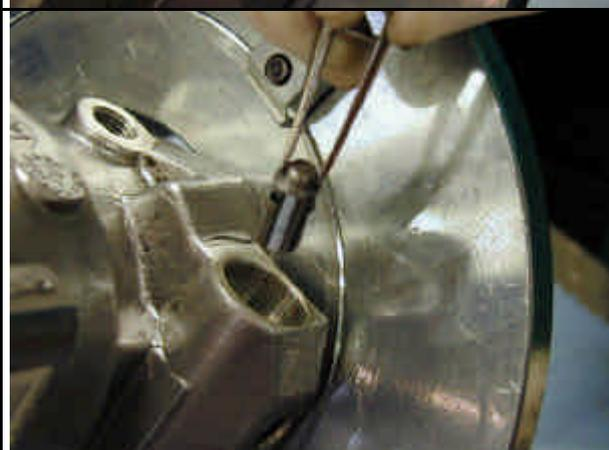
Levare il pistone della valvola di trasferta, lucidare la superficie di scorrimento
