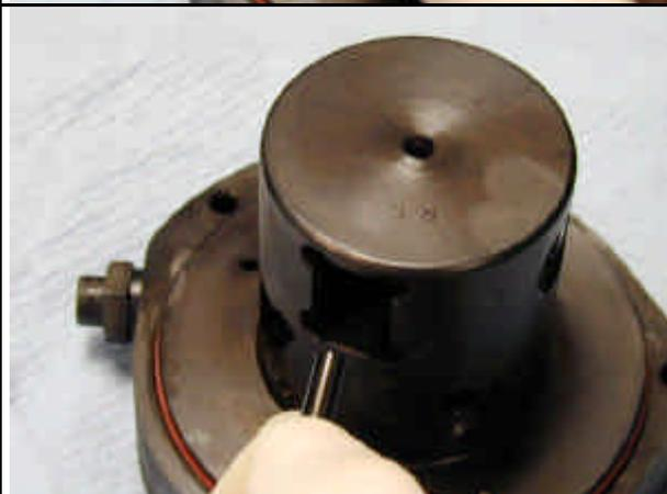
Sfilare i pompanti conservando la loro posizione iniziale, anche durante il rimontaggio
