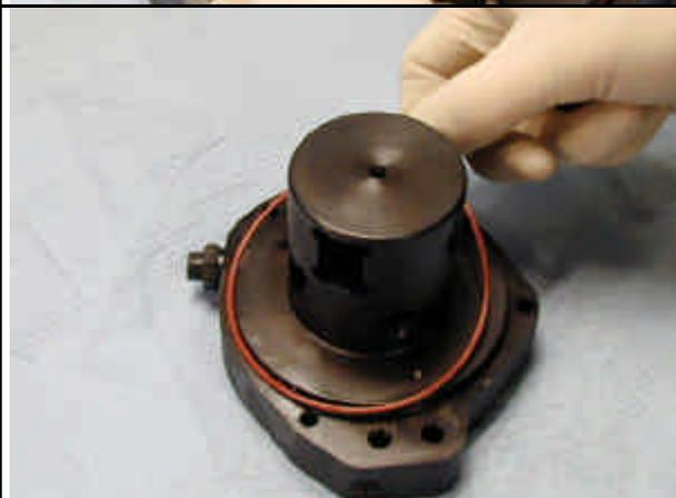
Estrarre la guarnizione della testa idraulica
