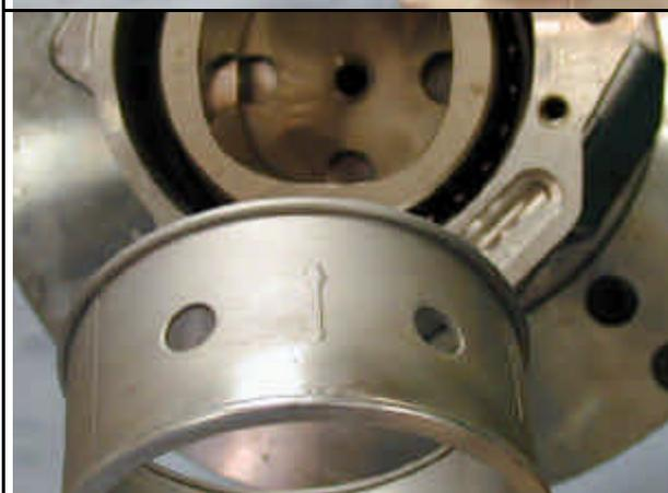
Estrarre lo spessore tra la testa e l'albero, notando la posizione delle frecce per il rimontaggio
