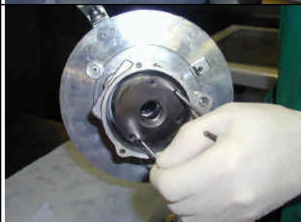
Estrarre la pompa alimentazione utilizzando due perni
